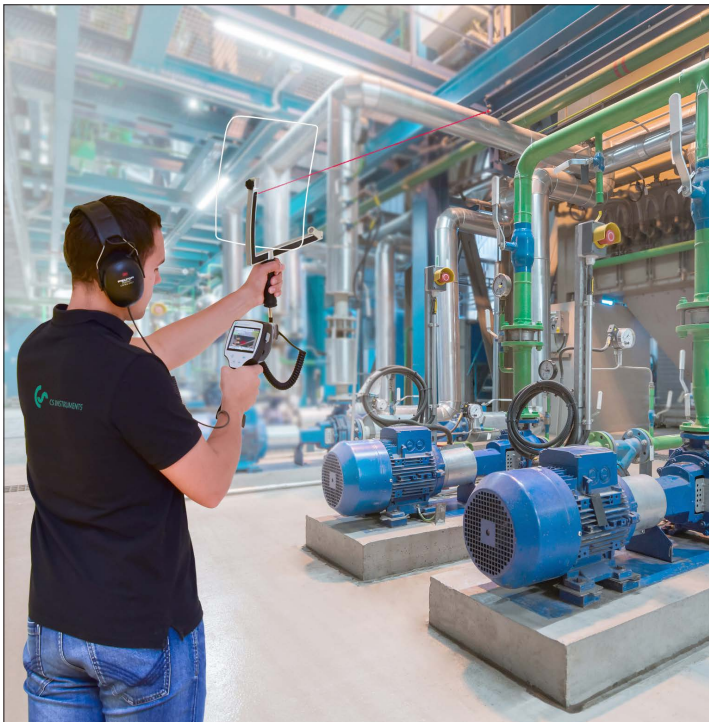
Lazer pointer ve entegre kamera ile çalışır durumdayken hassas sızıntı tespiti
